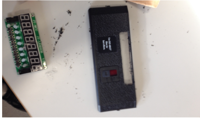
Figura 12. Primer prototipo. Observamos que se respetó el perímetro de la tapa trasera. Más tarde tuvimos que quitar el perímetro e imprimirlo en 3d.
