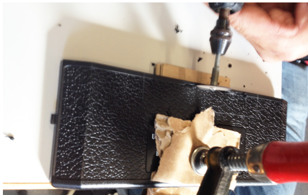
Figura 10. Perforando la tapa trasera con la Dremel.
