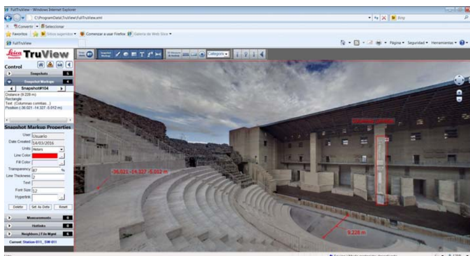
Fig. 14. Medición de precisión, Geolocalización y detalle de elementos sobre aplicación TruView™ de Leica®. 2016. Elaboración propia
