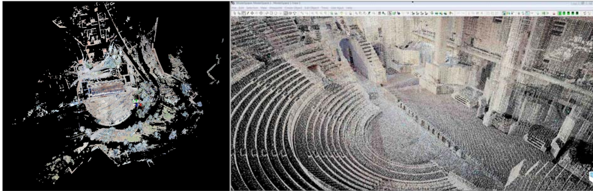
Fig 2. Nubes de puntos del Teatro Romano tratada con Cyclone™ de Leica®. 2016. Elaboración propia
