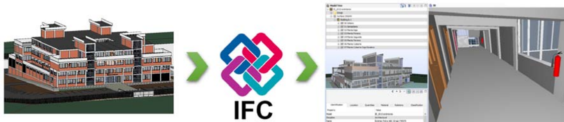
Figura 3. Modelo BIM, Modelo de datos IFC e interfaz web del software opensource para mantenimiento. 2016. Elaboración propia.
