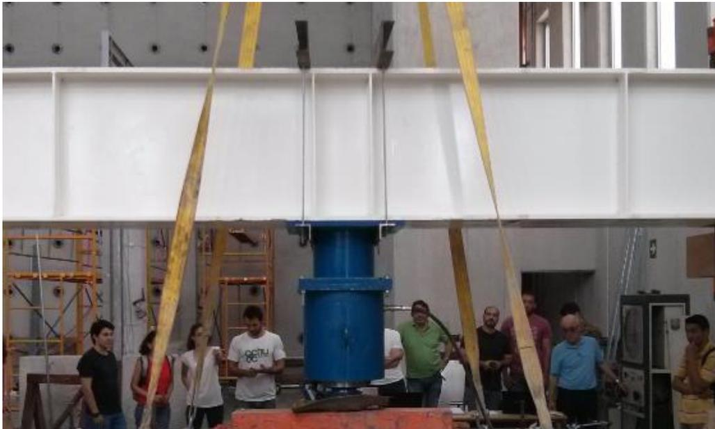
*Figura 56. Pistón hidráulico colocado en viga de carga*
