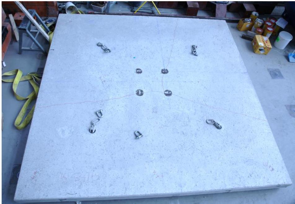
Figura 73. Patrón de fisuración en placa de HRFA
