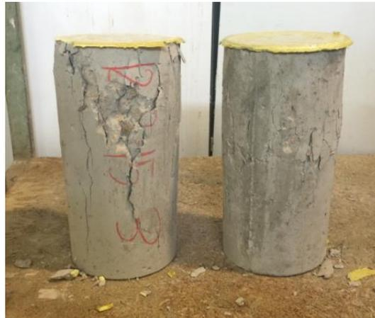
Figura 62. Aspecto de probetas luego de ser ensayadas a compresión, en la izquierda tenemos una probeta de HC y en la derecha una probeta de HRFA.
