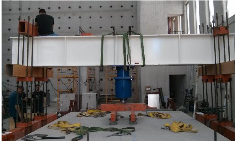
*Figura 54. Ajuste de viga de carga al pórtico.*
