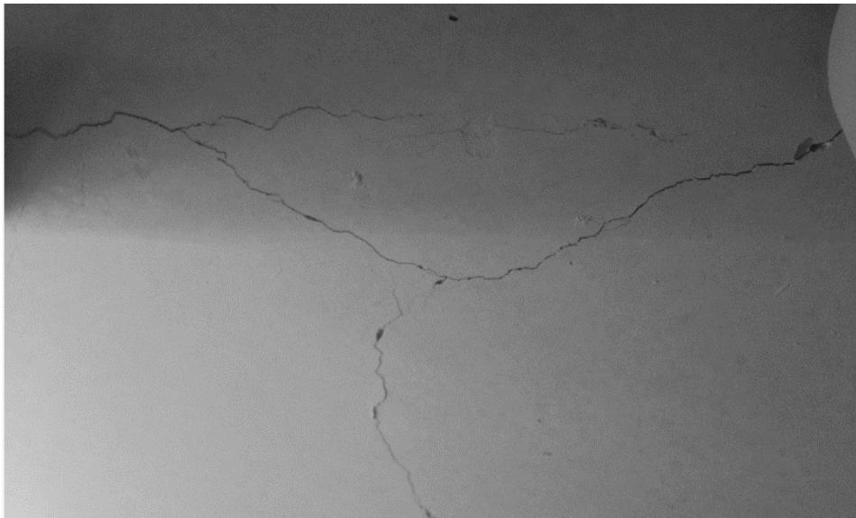
*Figura 82. Patrón de fisuración del centro de la placa en la cara inferior*
