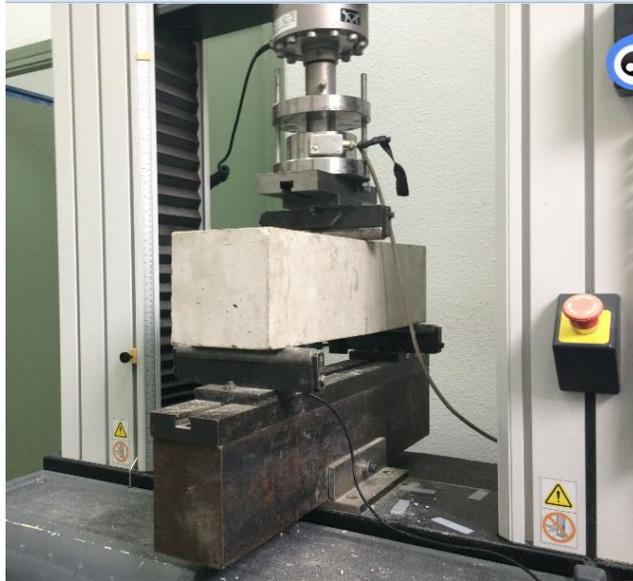
Figura 39. Ensayo de probetas a flexotracción
