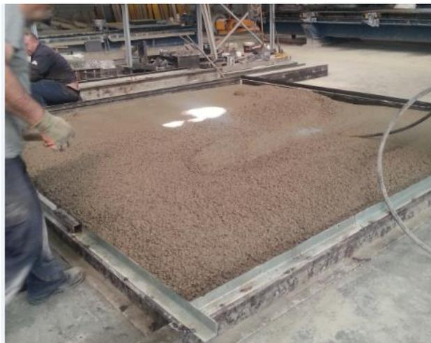
*Figura 30. Vibrado del hormigón*
