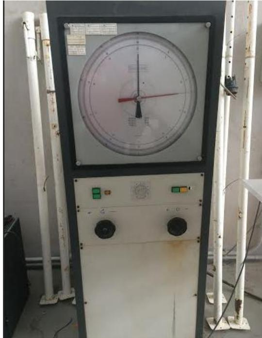
*Figura 57. Aplicador de carga manual*
