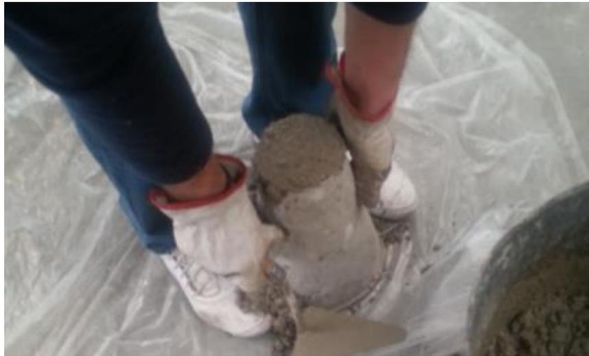
*Figura 24. Preparación de ensayo de consistencia*
