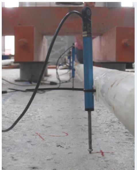
*Figura 58. Captador de desplazamiento de 50mm*
