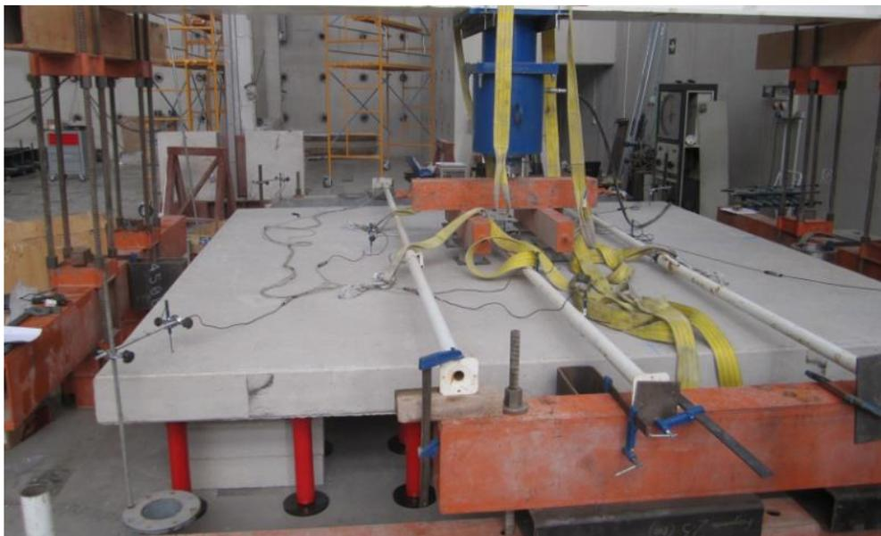
*Figura 55. Equipos de medición colocados en la placa.*
