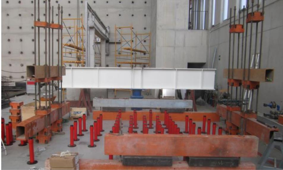
*Figura 46. En esta imagen se ve el desarrollo del paso 1, donde se ven colocados las vigas laterales, los apoyos y las torres.*
