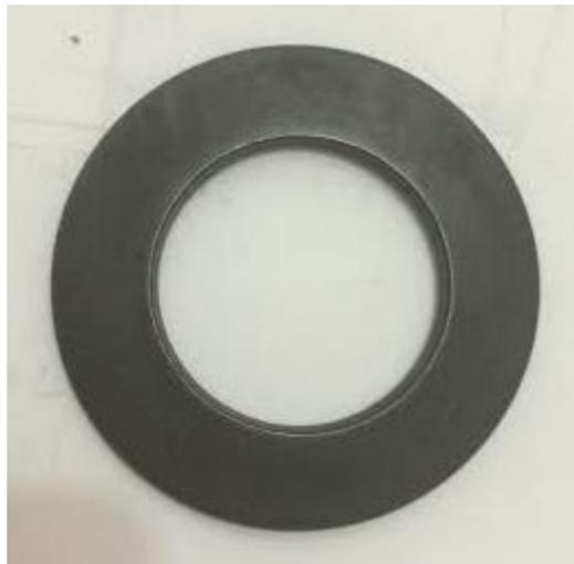
Figura 41. Muelles utilizados en el ensayo
