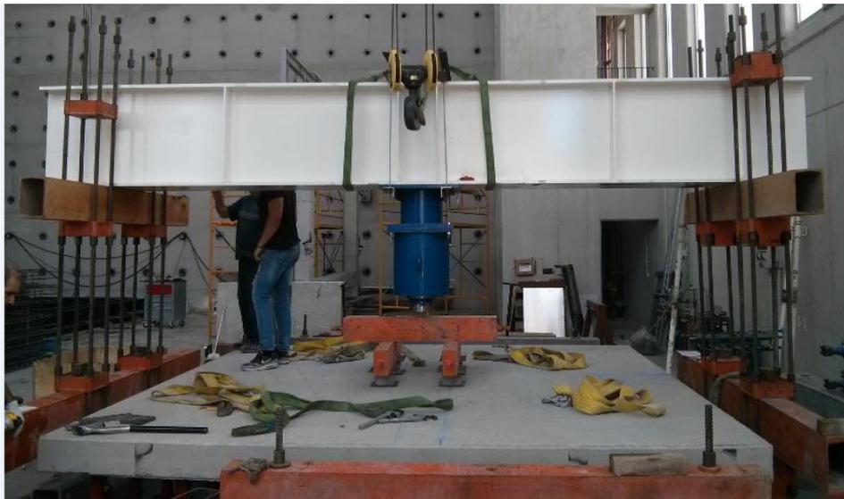
*Figura 53. Movilizado de viga de carga mediante puente grúa al pórtico.*
