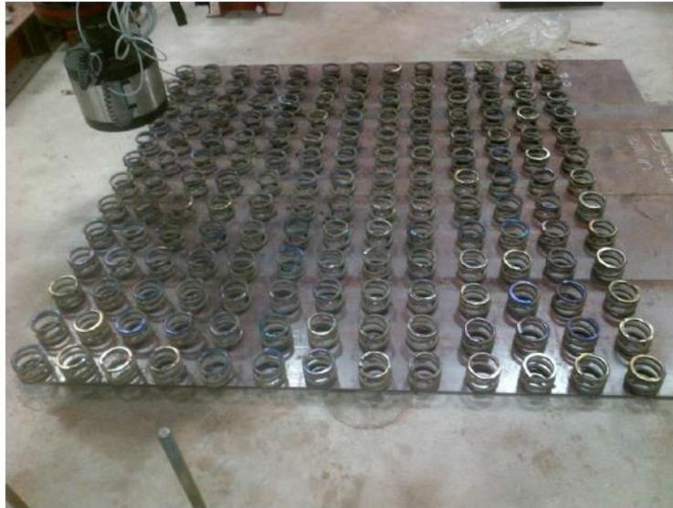
Figura 20. Distribución de muelles utilizada (Bothma, 2013)
