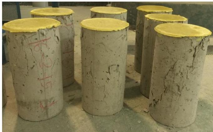
Figura 36. Aspectos de probetas ensayadas
