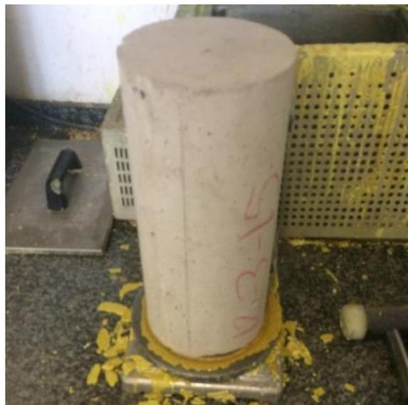
*Figura 34. Refrentado de probetas*
