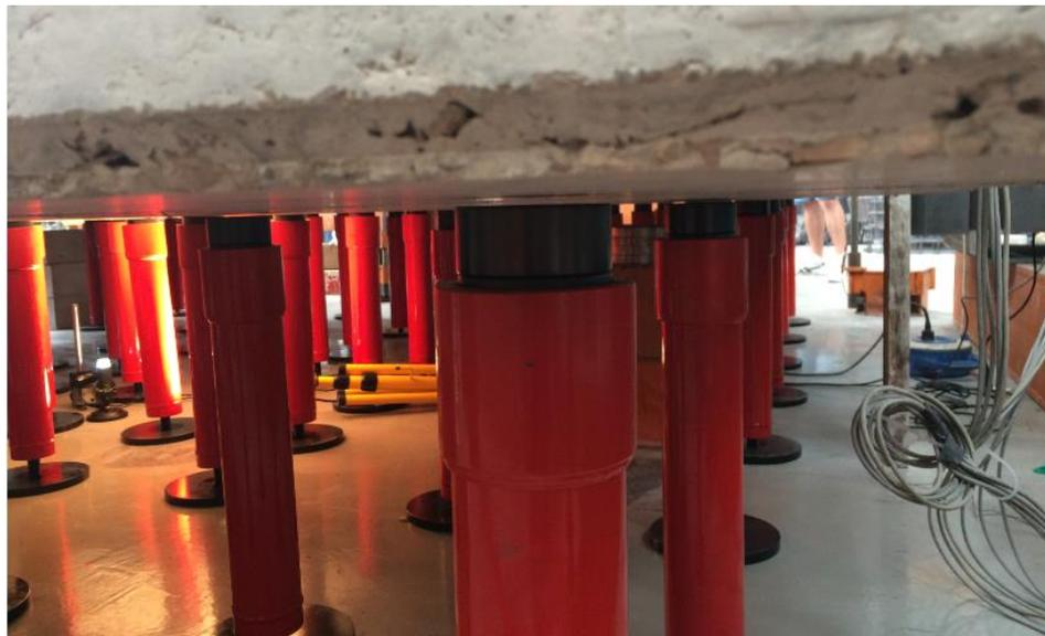
*Figura 75. Levantamiento de la placa de HRFA en esquina*
