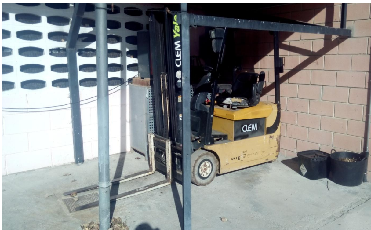
Imagen nº 23.- Carretilla elevadora de horquillas en voladizo.
