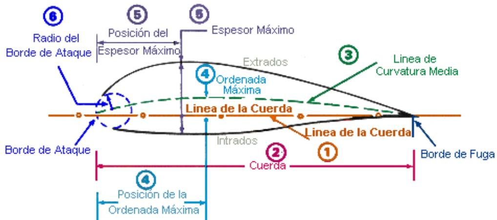
Los parámetros más importantes de estos perfiles son los coeficientes de sustentación ( $C_L$ ) y arrastre ( $C_D$ ), de los cuales depende la fuerza aerodinámica resultante del perfil.
