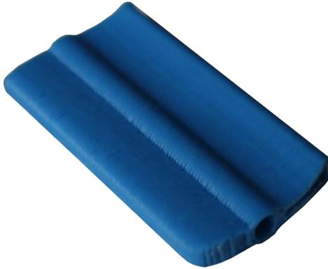
Este modelo no funciona correctamente debido a su poco peso en la parte inferior, se hace necesario un rediseño para incluir peso metálico en su parte inferior. Además el diferencial de resistencia aerodinámico entre la parte inferior y superior está muy igualado, lo que hace necesario aumentarlo.
