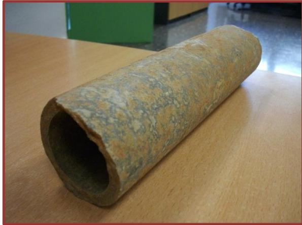
Fig. 6.11 Aspecto de la tubería de fibrocemento de un ramal de la red
