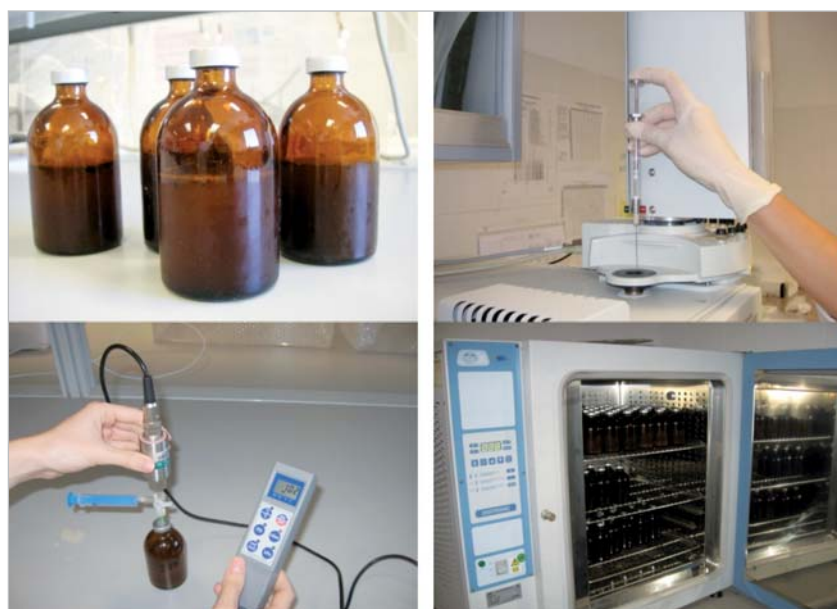
Figura 1. Distintas fases en la monitorización y determinación de la producción acumulada de biogás obtenido mediante ensayos de biodegradabilidad
