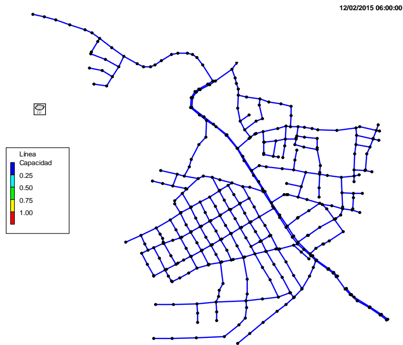
Figura 32. Simulación en tiempo seco primera proyección red. (SWMM 5.1)
