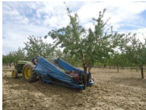
Figura 163. Acoplamiento al tronco.
