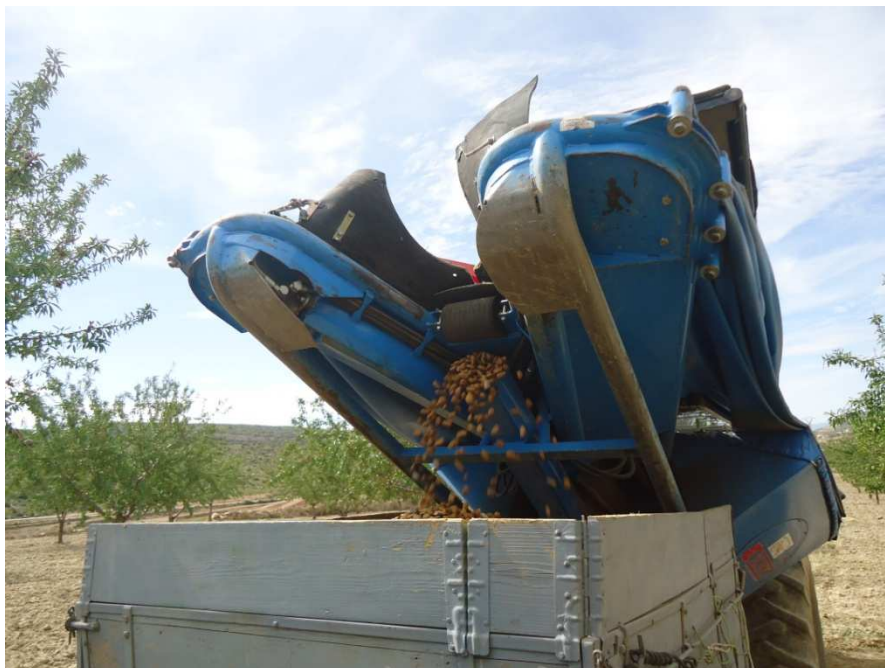
Figura 108. Sistema de descarga.
