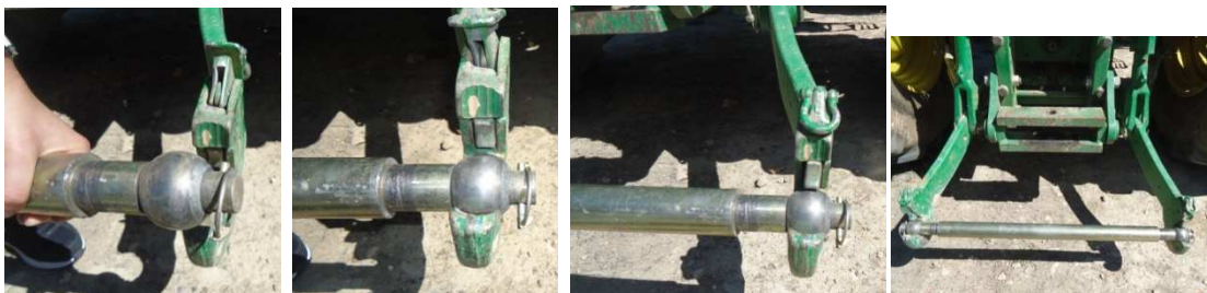
Figuras 150, 151, 152 y 153. Enganche de seguridad.
