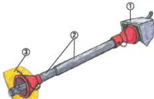
Figura 154. Elementos de protección del eje cardánico (2) y de las tdf (1 y 3).
