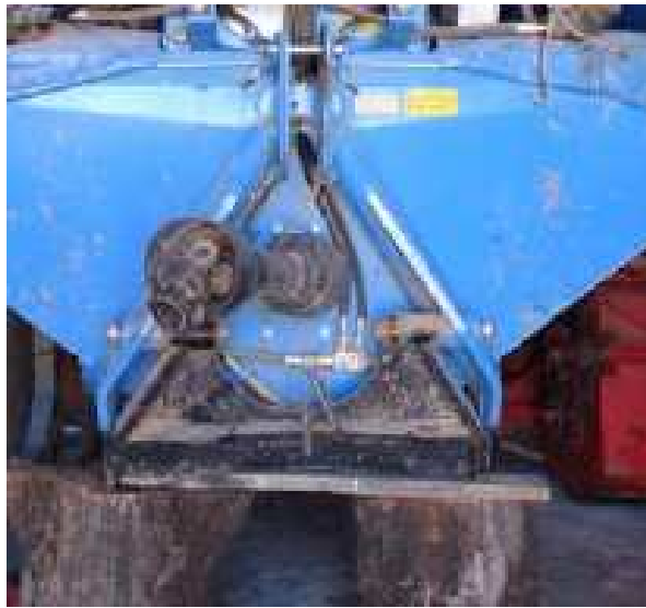
Figura 155. Toma de fuerza del vibrador.
