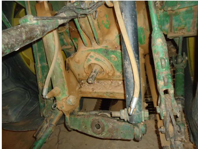
Figura 130. Toma de fuerza desprotegida.
