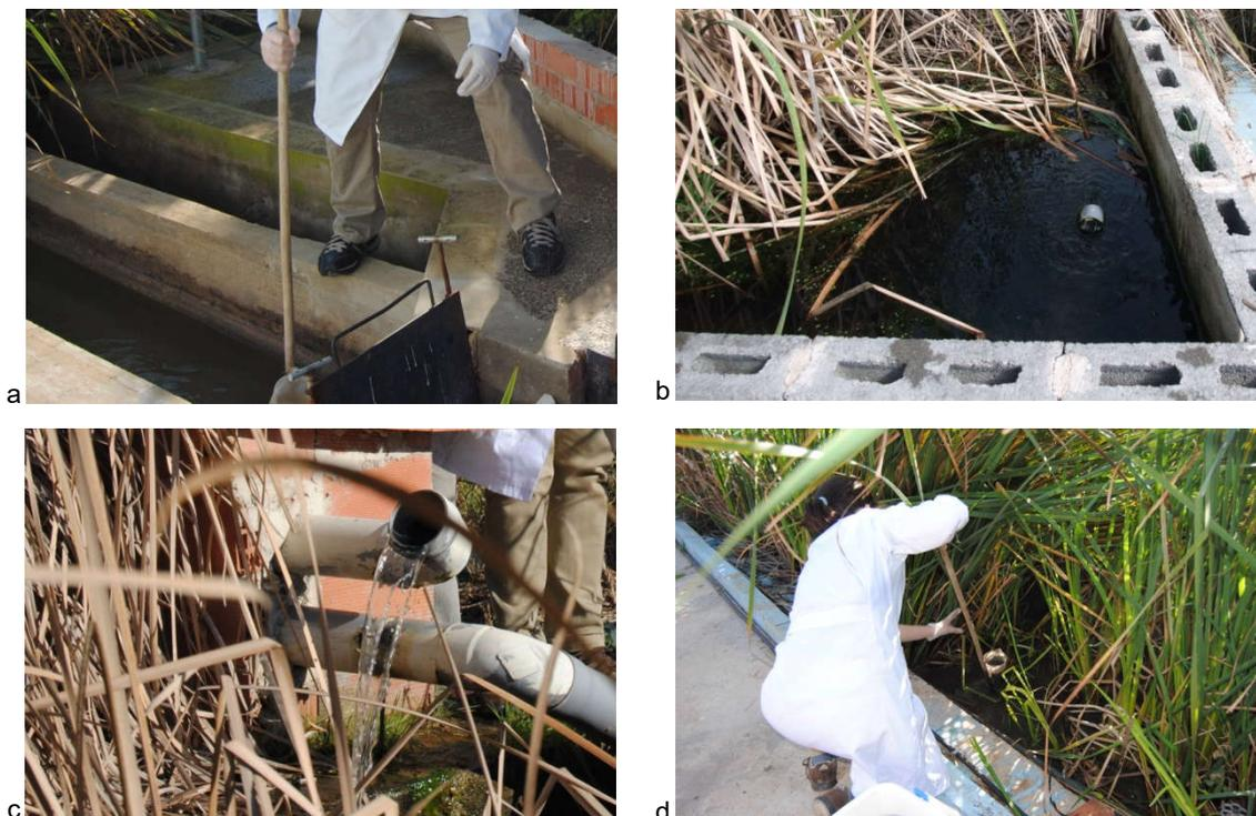
Figura 17: Puntos de muestreo de agua y licor mezcla: a) agua afluente (punto 1); b) agua efluente decantador secundario (punto 2); c) agua efluente planta (punto 3); d) licor mezcla (punto 4).
