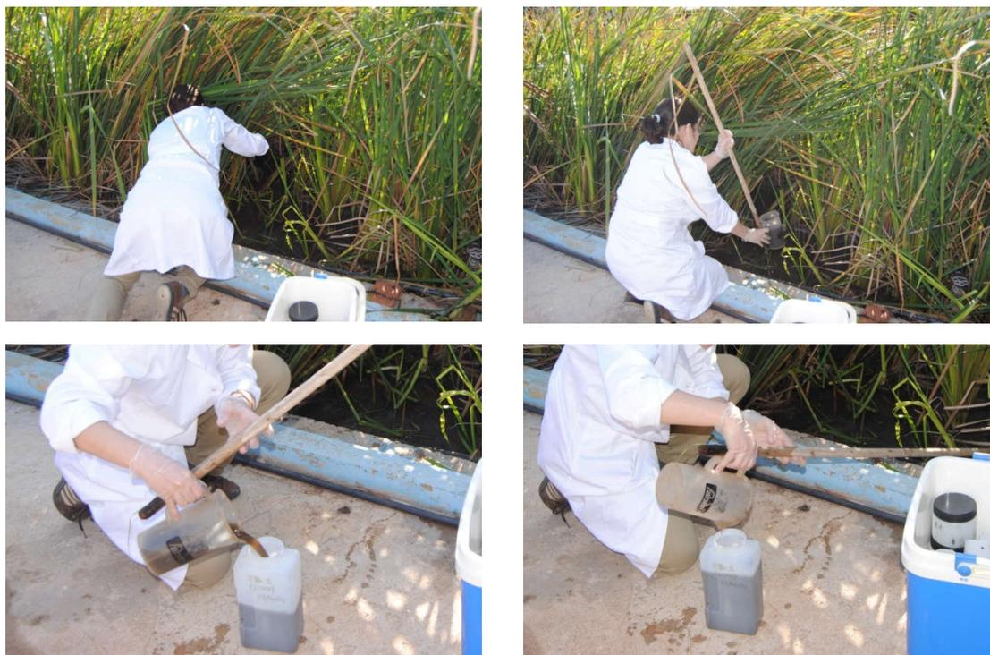
Figura 19: Proceso y material de empelado en la toma de muestras del licor mezcla.
