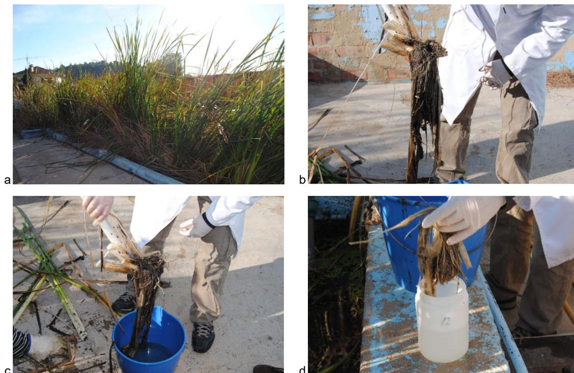
Figura 21: Toma de muestras del sistema radicular de las macrófitas del reactor biológico: a) vista general de reactor; b) zona radicular vegetación una vez extraída; c) proceso de lavado; d) almacenamiento.
