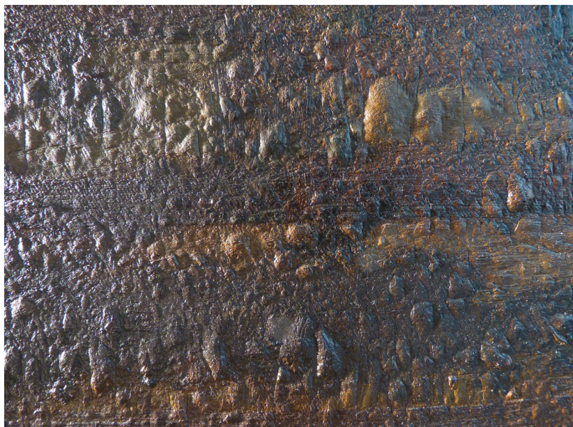
Imagen 2 | Ampollas de grado 3 con límite máximo de deformación plástica
