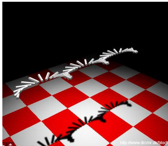
Figura 40. Los núcleos presentes en la izquierda tienen una velocidad de precesión más lenta que los de la derecha debido al campo magnético mayor en la izquierda [Hanson, 2016].
