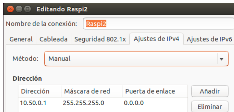
Ilustración 62: Configuración de red cableada en el pc.
