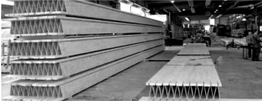
El forjado prefabricado de madera con el cual se van a construir los forjados de la intervención en la Lonja de Pescadores consiste en una serie de tablas y láminas de madera laminada, unidas con resinas epoxídicas, de manera que la propia geometría le da la resistencia, como si de un papel plegado se tratara.
