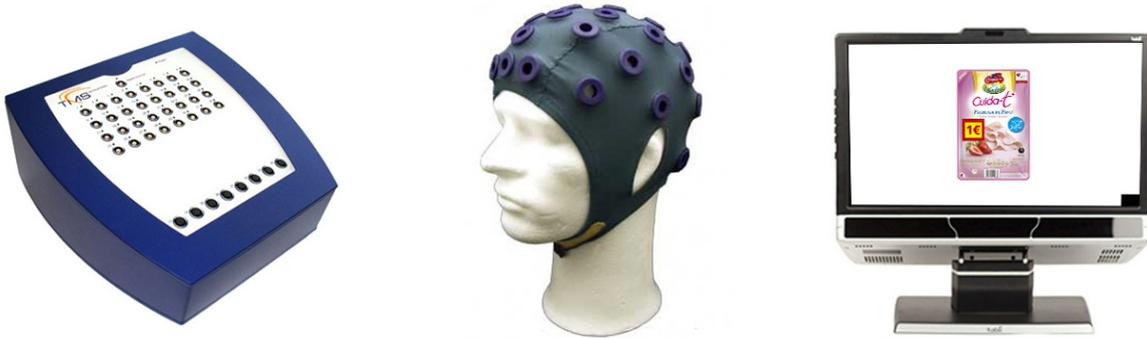
Figura 73. Dispositivo EEG TMSI -Refa (izquierda), Gorro 10-20 (centro) y Eye-tracking Tobii TX300 con pantalla incorporada (derecha).
