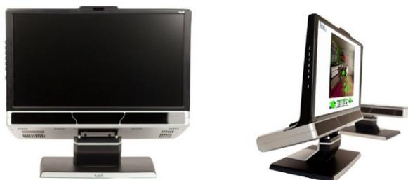
Figura 36. Dispositivo de Eye-tracking Tobii TX300 con pantalla incorporada.
