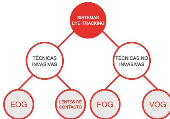
Figura 17. Tipos de sistemas de Eye-tracking (reproducido de Holmqvist, K. et al., 2011).
