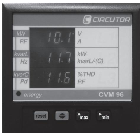
Figura 0.4. Fotografía del analizador de energía empleado en las diferentes prácticas mostrando lectura de tres tensiones de línea.
