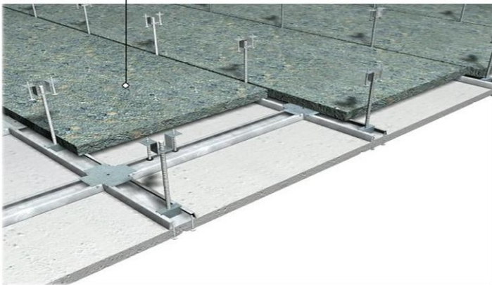
Aislamiento sobre falsos techos con complejos insonorizantes multicapa
