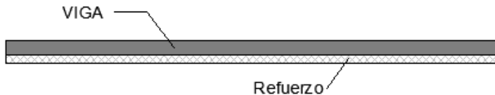
Ilustración 41 Refuerzo viga madera con colocación pletina o perfil en zona inferior. Fuente propia
