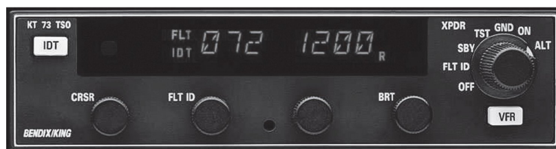
Fig. 2.3: Transpondedor Bendix/King KT 73
