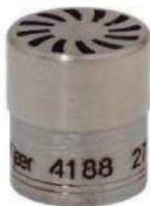
Figura 36 .Micrófono de condensador de campo libre.
