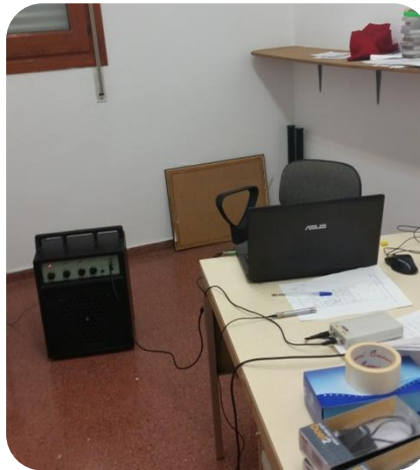
Figura 40 . Momento de la medición con la fuente, Dirac y el micrófono
