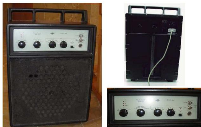
Figura 39. Fuente sonora Brüel & Kjaer modelo "Sound Source Type 4224"
