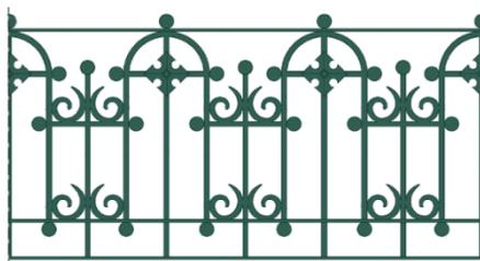
Figura 44. Levantamiento en CAD barandilla de la fuente. 2015. Fuente propia.
