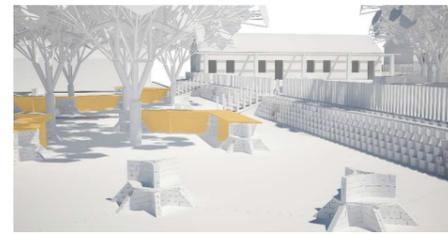
Para facilitar y aligerar el montaje de los puestos del mercado, se diseñan tres piezas básicas, dos de ellas conforman un pilar central que colabora con los tocones cerámicos, mientras que la tercera pieza sirve como superficie de la mesa. Existen dos geometrías diferentes para las piezas de mesa en función de la disposición de su contigua.
