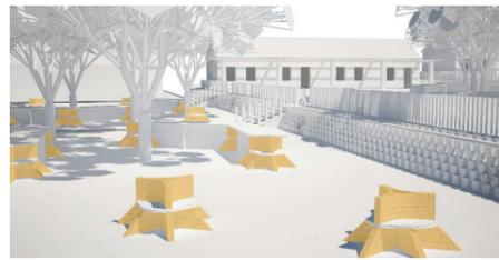
Las piezas de reposo se materializan con hileras de ladrillo, más una pieza central de madera, de la sección transversal de un árbol, redibujando su silueta a modo de asiento. Ambas piezas se mantienen resistentemente unidas al hormigonar el hueco interior.
