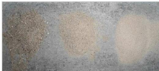
Imagen 32: Fracción 1,5 mm, Fracción 0,8 mm y Fracción 0,4 mm (de izquierda a derecha). Fuente: Elaboración propia.
