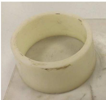
Imagen 53: Cono normalizado y empleado para el ensayo de principio y final de fraguado. Fuente: Elaboración propia.
