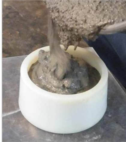
*Imagen 50: Vertido del mortero en molde troncocónico normalizado. Fuente: Elaboración propia.*
