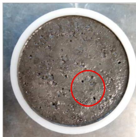
*Imagen 51: Hueco generado en la pasta que indica el inicio de fraguado. Fuente: Elaboración propia.*
