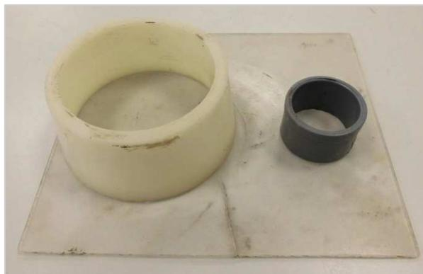
Imagen 40: Molde troncocónico normalizado (izquierda) y tubo de PVC no normalizado (derecha). Fuente: Elaboración propia.
