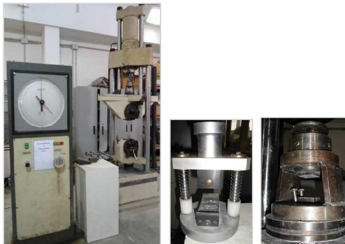
Imágenes 47,48 y 49: Máquina de ensayos a compresión, dispositivo de flexión y dispositivo de compresión. Fuente: Elaboración propia.
