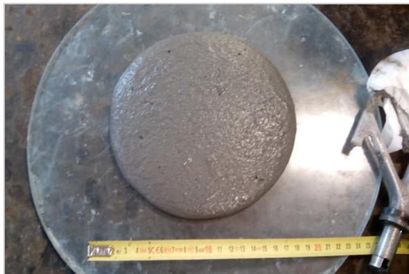
Imagen 52: Galleta estabilizada al levantar el molde. Fuente: Elaboración propia.
