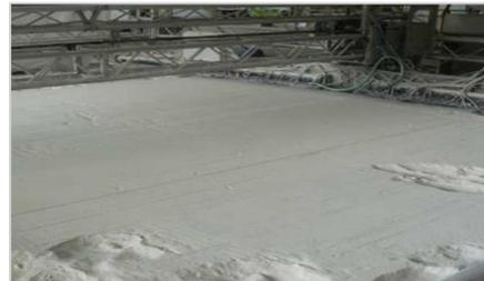
Imagen 16: Deposición de la mezcla seca. Fuente: [40].
