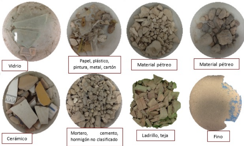
Figura 10.3: Identificación de los componentes por separación manual de los RCD.
