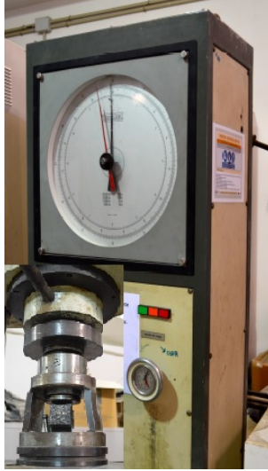
Figura 4.25: Equipo de ensayo a compresión.
