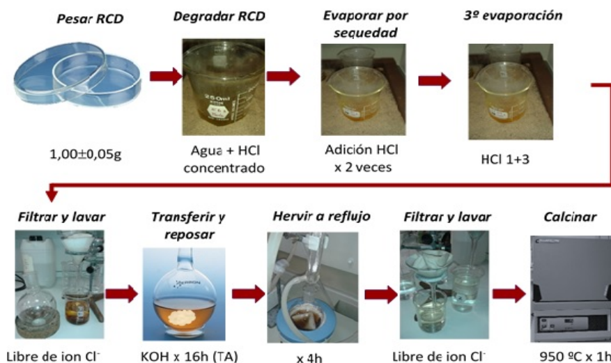
Figura 4.21: Esquema de ensayo R.I.
