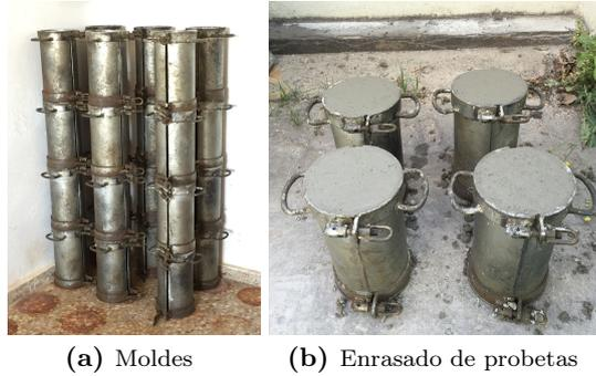
**Figura 3.19:** Fabricación y elaboración de probetas.
