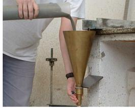
Figura 4.9: Ensayo del cono de Marsh.
