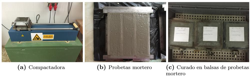
**Figura 3.7:** Probetas para determinación de resistencias mecánicas cementos.
