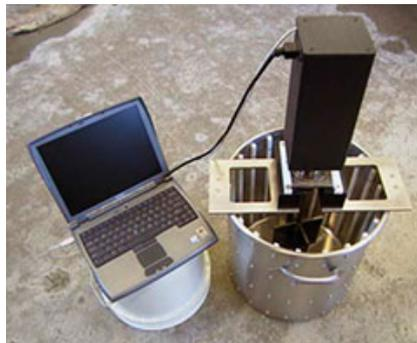
**Figura 2.25:** Reómetro ICAR.
