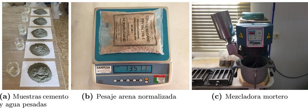
**Figura 3.6:** Realización de morteros para determinación de resistencias mecánicas cementos.
