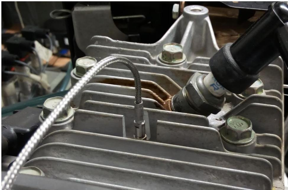
*Figura 1. 57. Captador piezoeléctrico de presión en cámara.*
