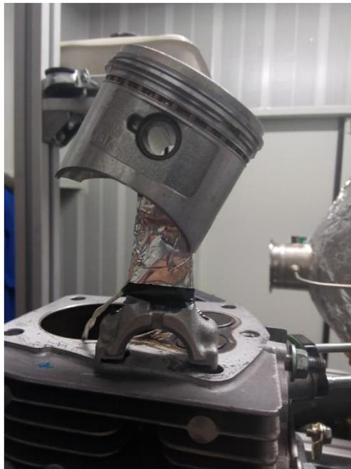
*Figura 1. 51. Biela preparada para ser montada en el MCIA.*
