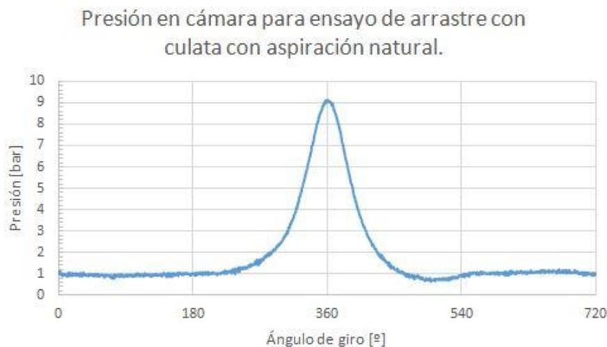
Figura 1. 62. Presión medida en cámara en un ciclo.
