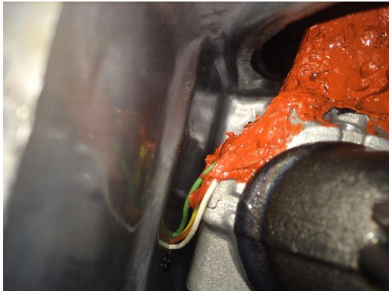
Figura 1. 53. Roce de los cables con el bloque motor.
