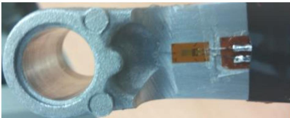
*Figura 1. 49. Biela instrumentada con la galga.*
