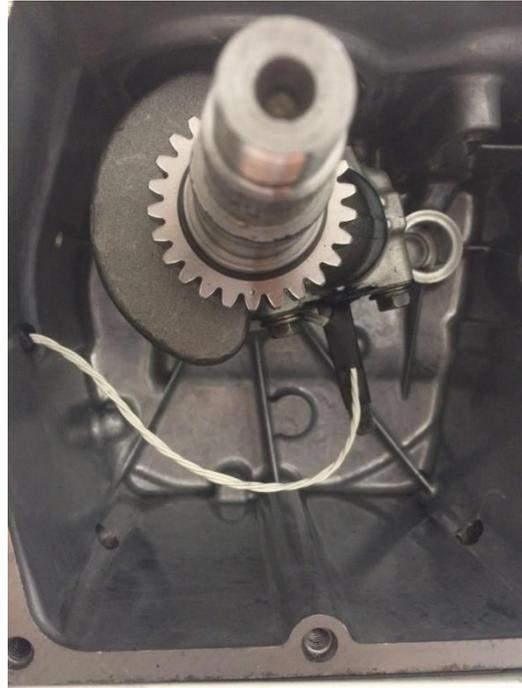
Figura 1. 54. Posición final de los cables en el bloque motor.
