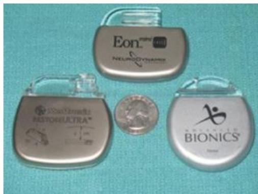
**FIGURA 3. Generadores de pulsos totalmente implantables, recargables y no recargables (Epstein y Palmieri, 2012).**
