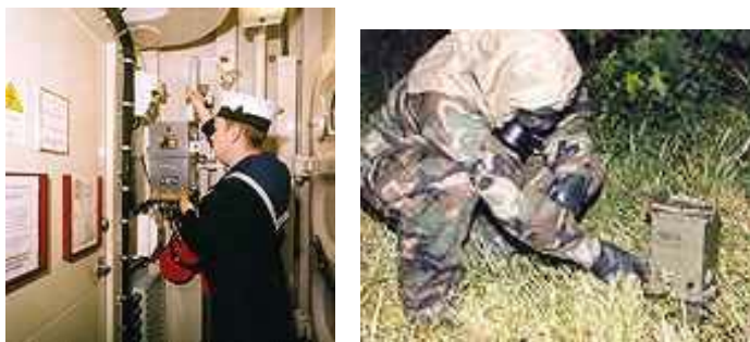
Sistema de detección de agresivos químicos instalado en un navío de combate y soldado con equipo NBQ monitorizando el terreno con equipo para detección de agresivos químicos.
