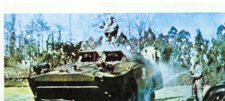
Descontaminación de vehículos, mediante lavado a presión efectuado por un operador protegido, la zona es limpia de contaminación pero el operador puede verse afectado por la desprendida del vehículo.
