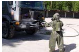
Descontaminación de vehículos, mediante lavado a presión efectuado por un operador protegido, la zona es limpia de contaminación pero el operador puede verse afectado por la desprendida del vehículo.
