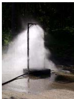
Ducha portátil de alta presión para descontaminación exterior, observar la dispersión lateral
