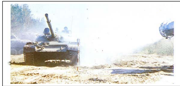
Descontaminación sobre "sobre la marcha" de un carro blindado, sometiéndolo a un chorro de fluido descontaminante.
