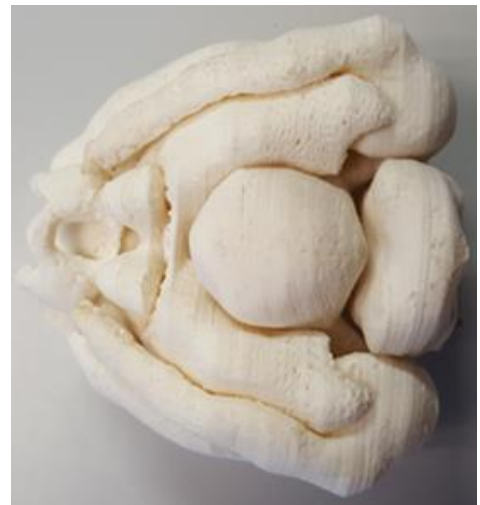
Figura 35. Prueba de impresión 1. Las piezas encajan correctamente pero no poseen uniones.
