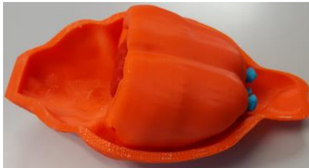
Figura 38. Prueba de impresión 4. Se observa una mejor calidad superficial respecto a la impresión 2.
