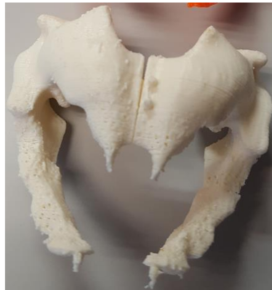
Figura 37. Prueba de impresión 3. Se observa una mala unión debido a la dilatación del material.
