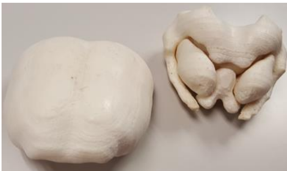
Figura 43. Piezas correspondientes a la impresión 1 después de realizarse en tratamiento con acetona.
