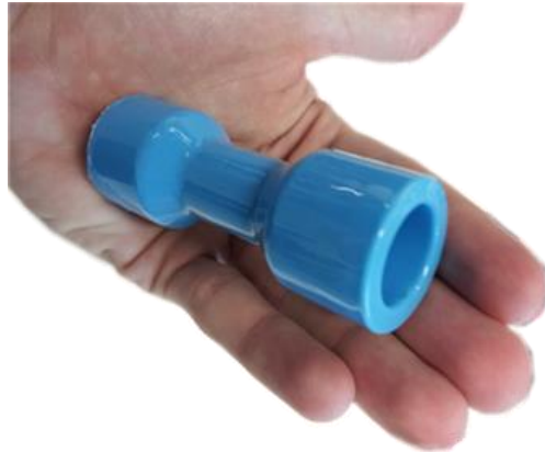
Figura 8. Pieza de ABS suavizada con vapor de acetona. Imagen de dominio público.
