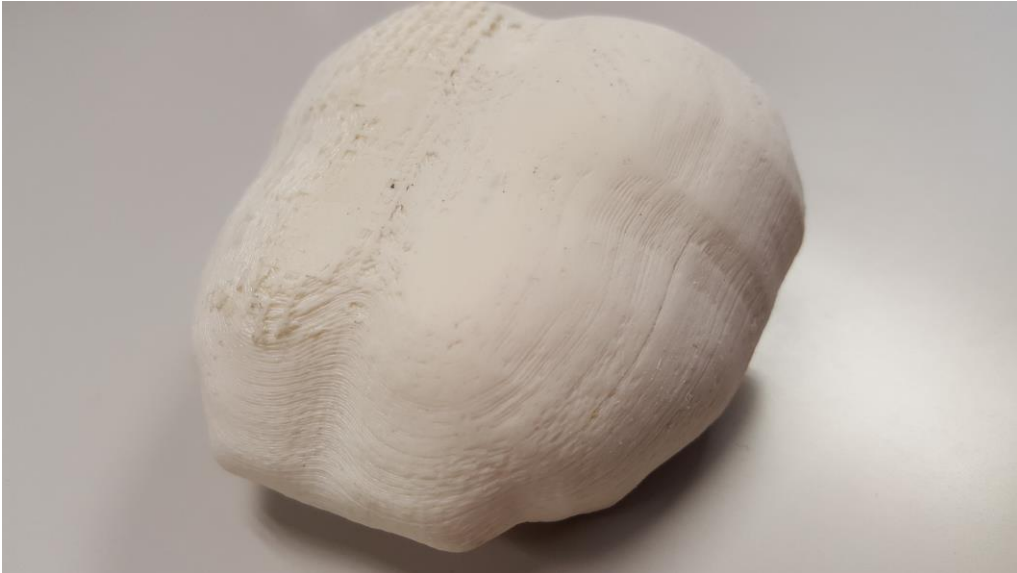
Figura 42. Neocórtex prueba de impresión 1. Se ha realizado un tratamiento mecánico de lijado a la mitad derecha, mientras que a la mitad izquierda solo se le ha retirado el material sobrante.
