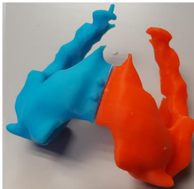
Figura 39. Prueba de impresión 5. Se observa una mejor calidad superficial respecto a la impresión 3.
