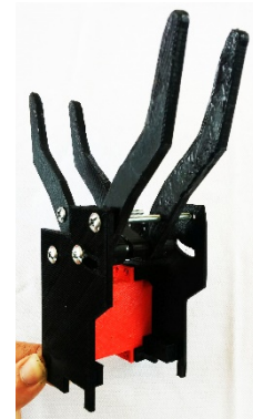
Fig. 166. Montaje del prototipo de la pinza. I.P.
