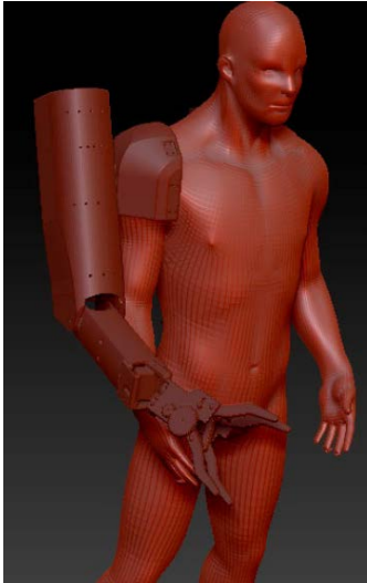
Fig. 167. Montaje del brazo robot en el cuerpo del paciente. Montaje efectuado con el software ZBrush. I.P.
