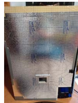
Fig. 163. Impresora recubierta de estructura aislante. I.P.
