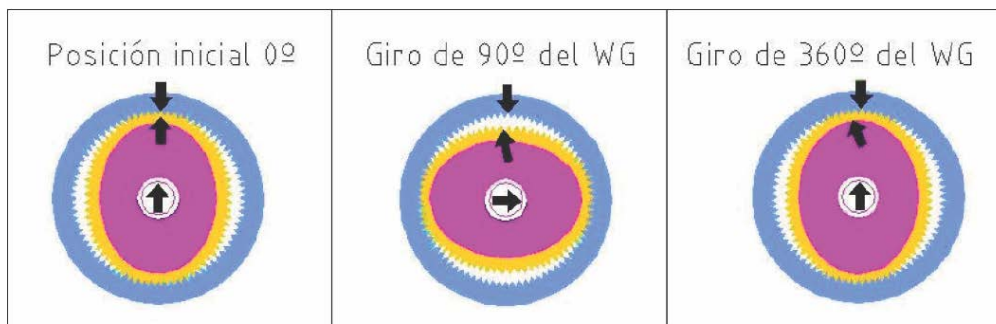
Fig. 61. Mecanismo de operación de un Harmonic Drive. Recuperado de Castejón, Garcia-Prada, & Lara, 2009.
