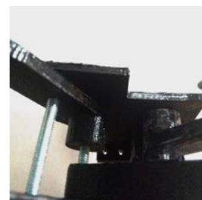
Fig. 169. Tornillo de unión de los dedos de la pinza. I.P.
