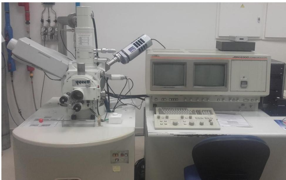
**Figura 21. Microscopio electrónico de barrido marca Jeol modelo JSM6300.**
