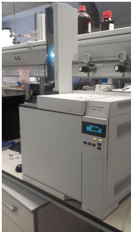
**Figura 22. Cromatógrafo de gases con detector de ionización por llama.**
