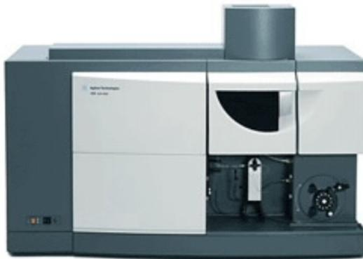
*Figura 4.3: Equipo ICP utilizado en la determinación de concentraciones de metales pesados en EC y pastas.*
