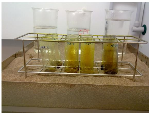
*Figura 5.82: Ataque ácido del material de partida en ciclos de ebullición en el baño de arena, previo a la determinación de metales.*
