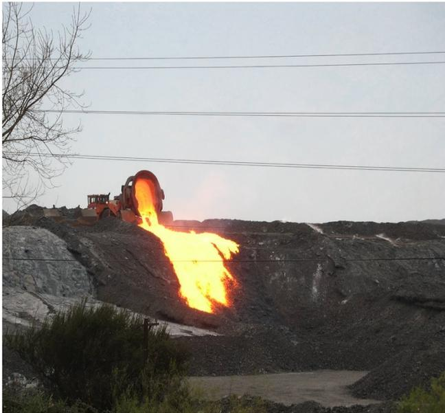
*Figura 2.1: Vertido y enfriamiento al aire de escoria de cobre de una fundición actual. [Foto: Carlos Danyau]*
