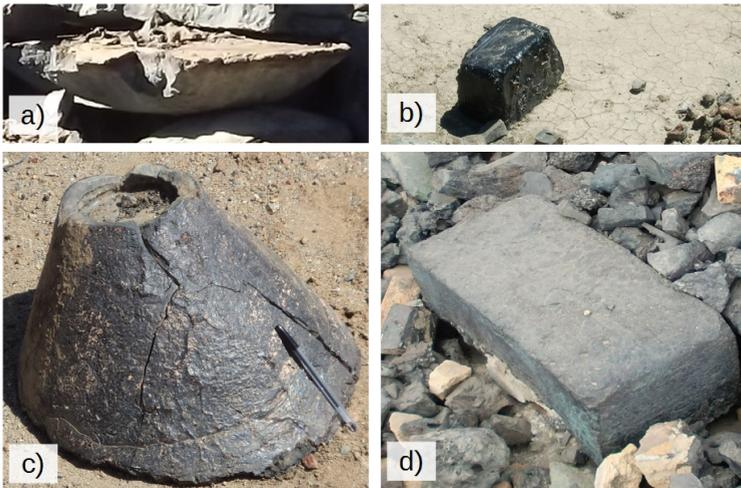
*Figura 2.9: Moldeo de escorias de cobre usadas en algunas fundiciones chilenas. a) forma semi-ovoide, b) prismática, c) cónica y d) prismática plana.*
