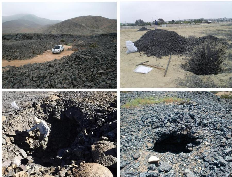
*Figura 4.2: Vistas de vertederos y calicatas practicadas para la toma de muestras de escorias de cobre antiguas.*
