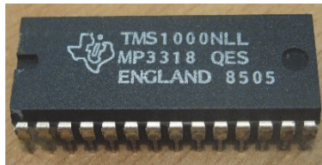
Figura 10.5. Texas Instruments TMS 1000, el primer microcontrolador comercial
