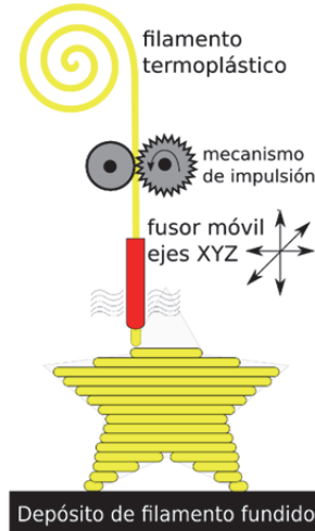
Figura 12.4. El proceso de depósito de filamento fundido
