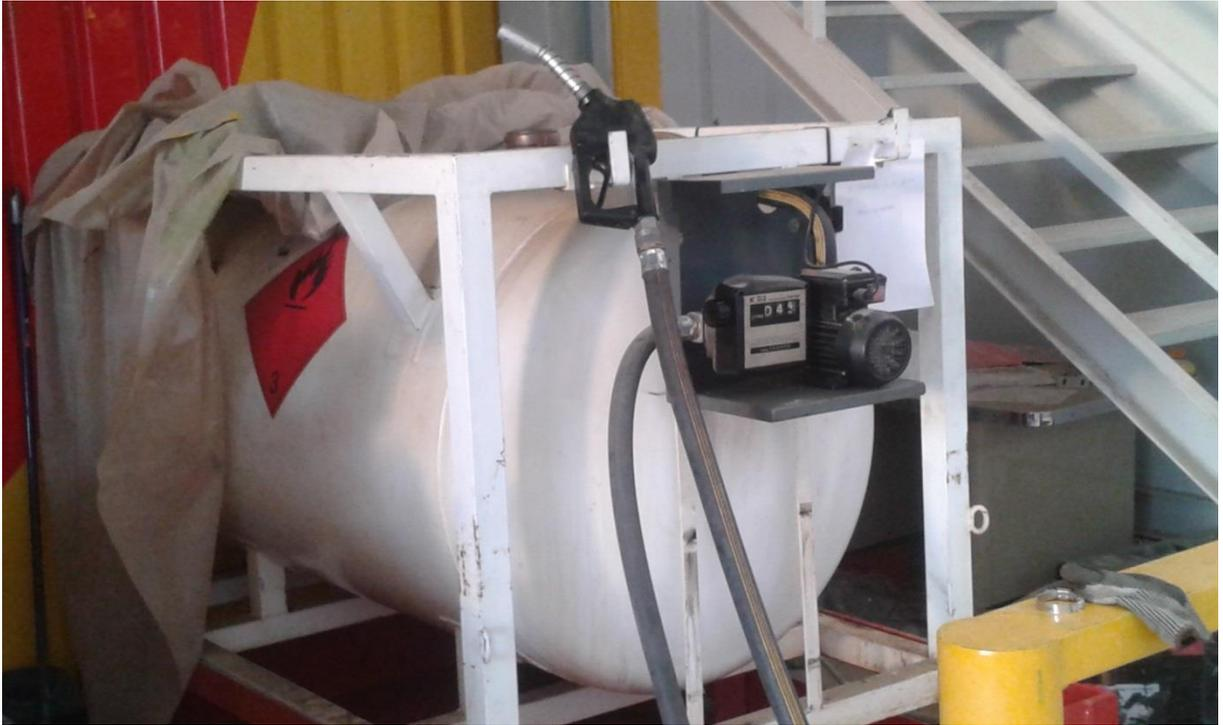
Fig. 32: GRG nuevo con contador y manguera
