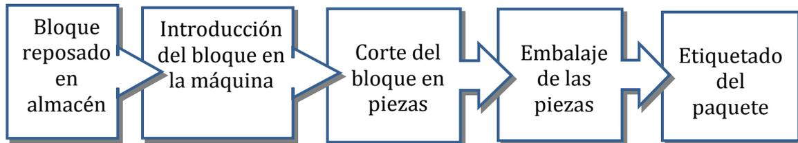
**Figura 37.** Diagrama del corte y embalaje. Multipantógrafo. (Fuente: Elaboración propia).
