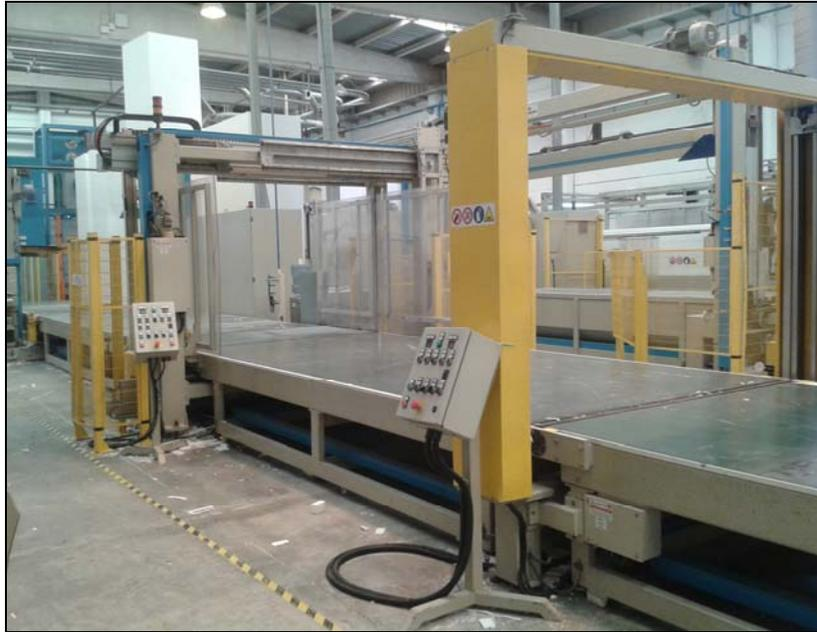
**Figura 36.** Multipantógrafo. (Fuente: Elaboración propia).
