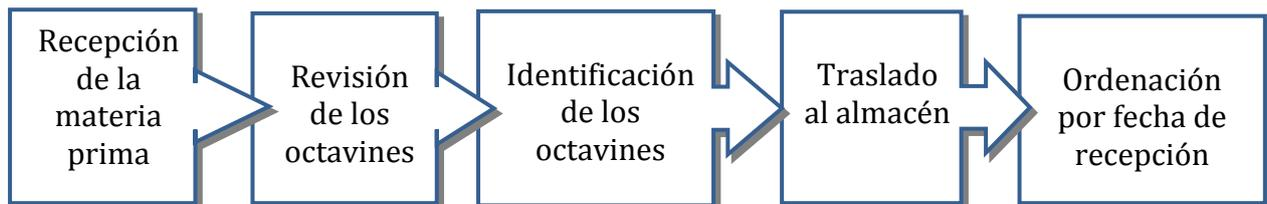
**Figura 41.** Diagrama de la recepción de la materia prima. (Fuente: Elaboración propia).
