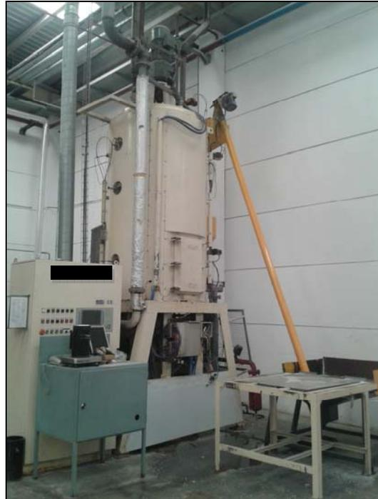
**Figura 30.** Preexpansor sección corte. (Fuente: Elaboración propia).
