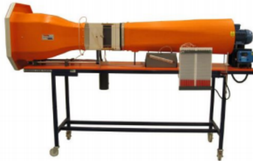
Figura 1.1: Túnel de viento de circuito abierto de la Universidad Politécnica de Valencia.
