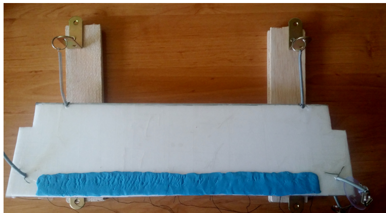
Figura 4.8: Proporción y dimensiones de la plastilina en la placa plana.
