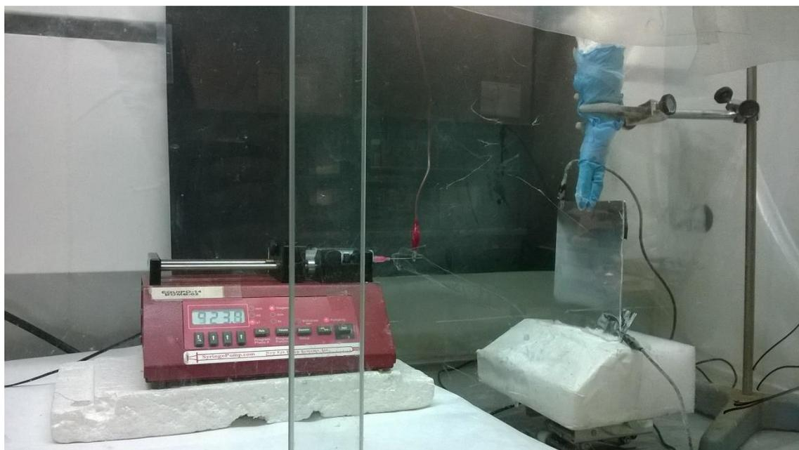
*Figura 7. Montaje de electroespray con placa colectora con papel de aluminio.*
