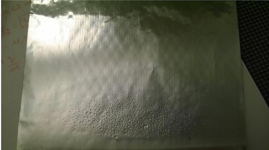
*Figura 8. Gotas formadas durante el proceso de electroespray con disolución de 4% utilizando las condiciones de la Tabla 5.*
