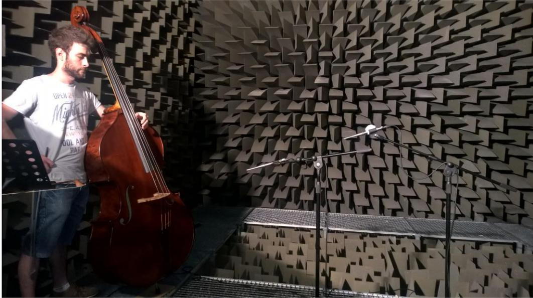
*Figura 30: Posición de los micrófonos y del contrabajo durante la grabación de la cámara anecoica de Gandía*
