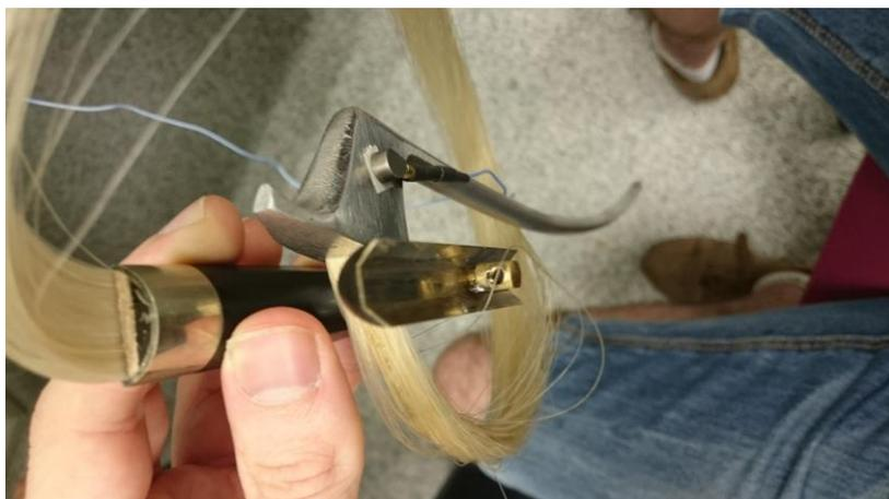
Figura 31: Acelerómetro instalado en el arco de aluminio
