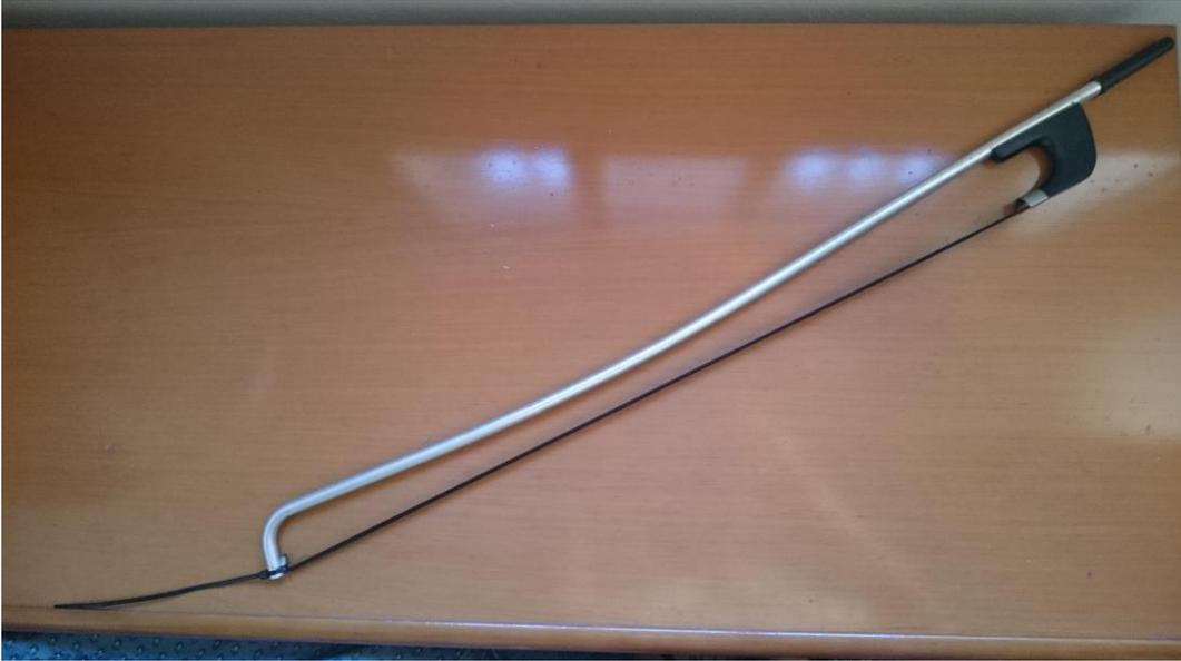
*Figura 19: Arco de aluminio prototipo*
