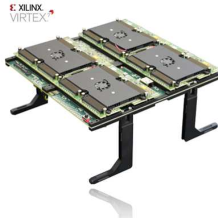
Figura 3.1: Placas de prototipado multi-FPGA, incorporando cuatro dispositivos FPGA V2000T de Virtex, interconectados entre sí.
