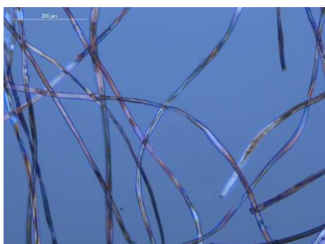
Figura 23. Microfotografía de algodón y algodón mercerizado mezclado del conjunto CR02, luz polarizada 135°, X10.
