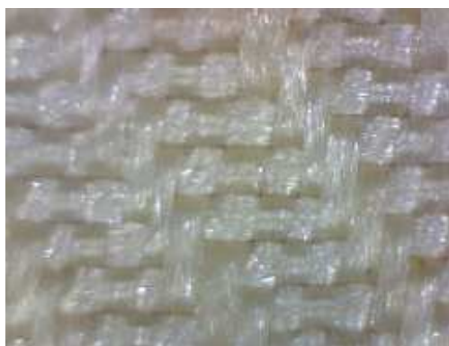
Figura 64. Macrofotografía de ligamento sarga romana 1e^5 b 1,1,1,3 dirección S, tejido de forro del conjunto C12.
