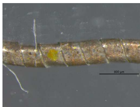
Figura 54. Microfotografía de plata falsa en hilo entorchado con alma blanca de algodón del conjunto C19, X40.
