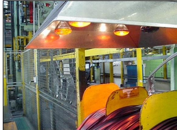
FIGURA 8.12 y FIGURA 8.13: Lámparas de calor instaladas en la línea de puertas.
