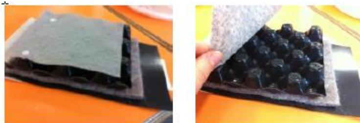
*Figura 4.9. Filtro de protección y acumulación (conjunto del paquete Seic). En orden ascendente se encuentra la membrana ZD UV, el filtro Seic-MediPro MP 300, el elemento MediDrain MD 25 y la tela filtrante MediFilter MF 1.*
