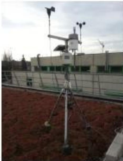
Figura 5.1. Estación meteorológica Onset Hobo U30.
