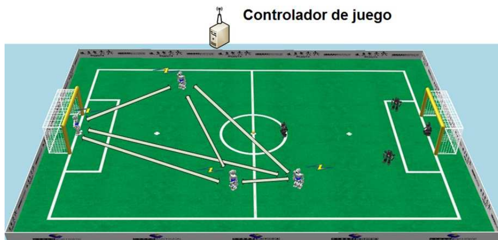
Figura 1.2. Arquitectura de equipos de fútbol de robots con control distribuido.
