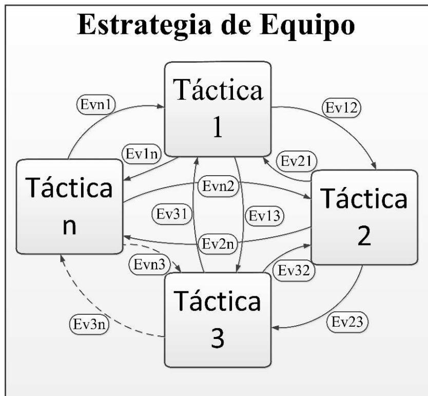
Figura 3.1. Primer nivel de la Máquina Jerárquica de Estado Finito para el sistema de toma de decisiones. Este nivel selecciona la táctica.
