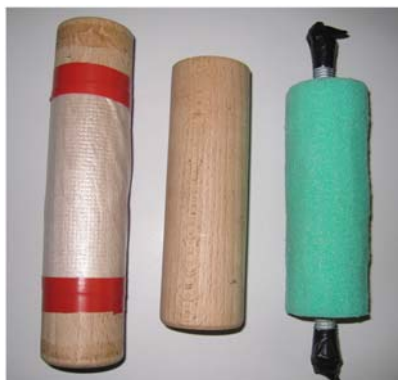
Figura 4.3. En la izquierda el cilindro envuelto con entre una y cinco láminas de espuma empleado para evaluar la evolución de la dureza. En el centro y en la derecha el cilindro de madera y de espuma lastrado con una barra de acero empleados para evaluar la influencia del punto de agarre con la estimación de la dureza.
