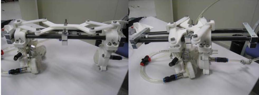
Figura 5.13. Garra para mango con tres dedos con sistema de control de rigidez. A la izquierda abierta a la derecha cerrada.
