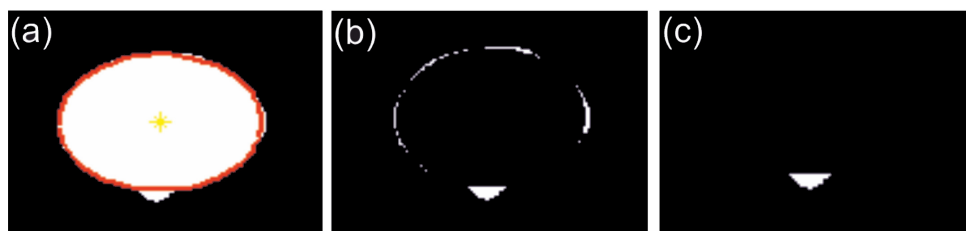
Figura 6.10. (a) Aproximación del disco por una elipse. (b) Objetos resultantes tras la resta entre la máscara del disco y la máscara de la elipse. (c) Selección de los objetos con un área superior a 15 \text{ mm}^2 .
