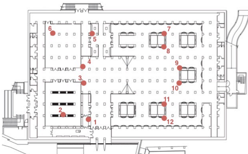
Figura 39. Plano de situación de las sondas de temperatura y humedad en el MHV (Fuente: Elaboración propia)
