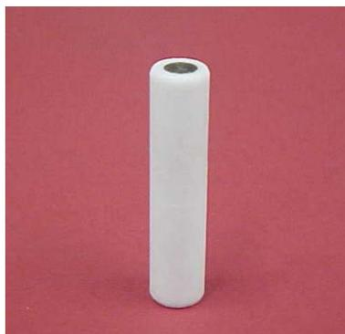
**Figura 4.2.** Imagen del material sustrato acero inoxidable AISI 304 (electrodo de trabajo).
