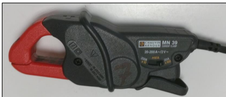
Figura 4.26. Pinza amperimétrica utilizada en el banco de ensayos.
