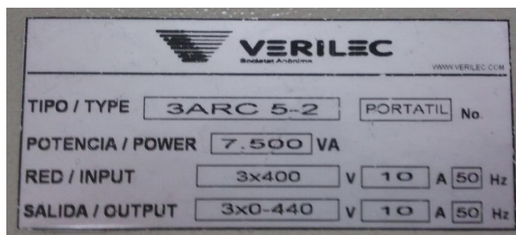
Figura 4.7 Placa de características del autotransformador Verilec 3ARC 5-2.
