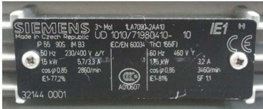
Figura 4.4 Placa de características del motor Siemens modelo 1LA7090-2AA10.
