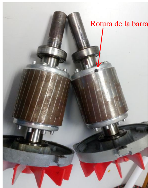
Figura 4.5 Fotografía que muestra el rotor sano y el rotor con rotura en una de sus barras.
