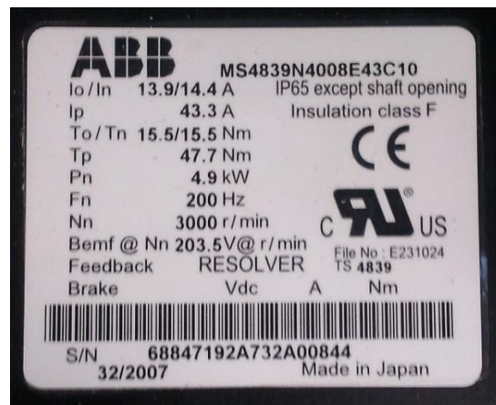
Figura 4.17. Placa de características del motor de imanes permanentes.
