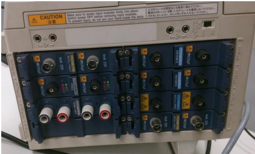
Figura 4.23. Tarjetas modulares del osciloscopio para muestreo.
