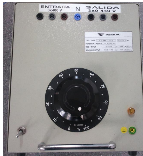
Figura 4.6 Autotransformador de la marca Verilec modelo 3ARC 5-2.
