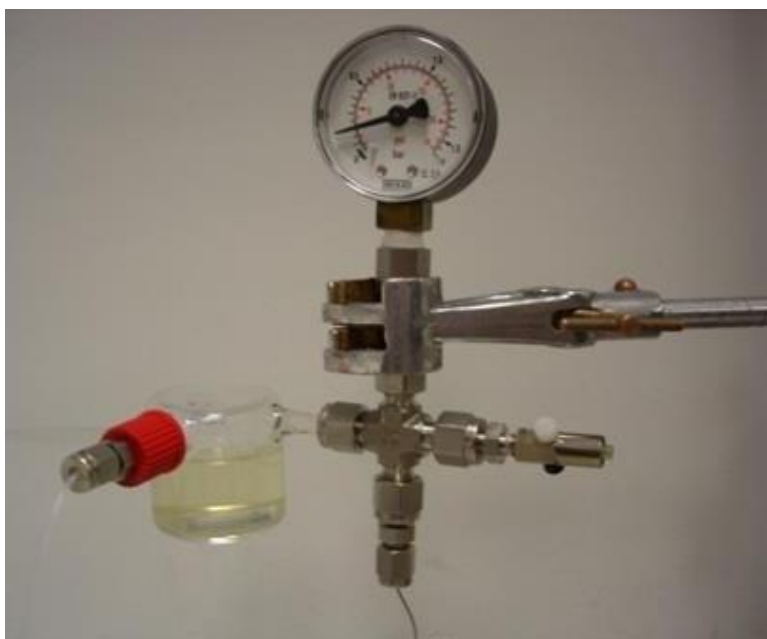
Figura 8.8- Fotografía del reactor fotocatalítico empleado en la determinación de actividad fotocatalítica de las muestras de (X)G para la generación de H 2 .
