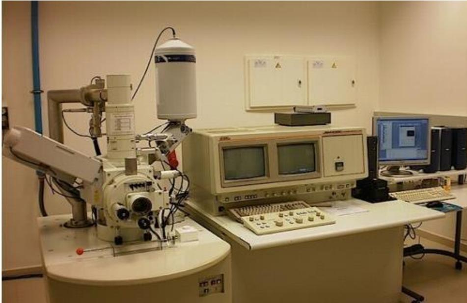
**Figura 15. Microscopio electrónico de barrido (SEM) con EDX.**
